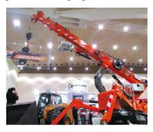
O modelo Jekko Diesel SPX 527 mede aproximadamente 4,2 x 1,1 x 1,9 m, pesa 3600 kg e suporta uma carga máxima de 700 kg. O tamanho do braço pode chegar a 12 m. O miniguindaste tem rotação de 360°.
