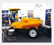
meio ambiente. Na feira, o destaque ficou para o Lean Dumper 850-E, veículo especialmente projetado para transporte e movimentação de materiais. É de dimensões reduzidas (menor que um automóvel econômico), manobrabilidade excepcional em terrenos estreitos, despreparados ou íngremes e de grande capacidade de carga em relação ao seu tamanho.
