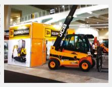
Durante a feira, a Equimáquinas deu destaque à retroescavadeira compacta modelo ICX, uma exclusividade JCB. Ela possui motor de 50hp, profundidade de escavação de 2,55m e caçamba 6 em 1 com 0,28m³. O peso operacional do equipamento é de 7.370kg.
